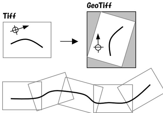
斜め図郭の場合、GeoTiffなどのデータに変換すると余白部分ができてしまいます。また、繋ぎ合わせると図郭が斜めになり画面の表示で用紙が傾いてしまいます。
