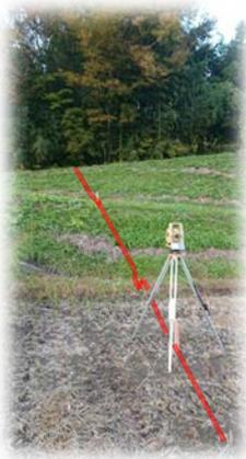
間接横断の観測は、センターもしくはセンター外に光波を設置するいずれのケースにも対応しています。画面上の『測距』ボタンを押せば、光波が計測を開始し野帳データを自動的に保存します。偏心にも対応し観測モードを途中でポール横断に切り換えることが可能です。観測結果は、即時にCRT図として結線描画を確認することができます。
