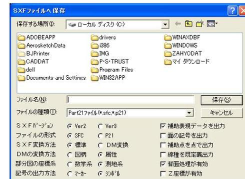
DM属性が付いていれば、SXF変換時にCAD製図基準のレイヤーに自動的に振り分ける機能を装着しています。DMを意識してデータ作成すれば、SXF変換は簡単です。
