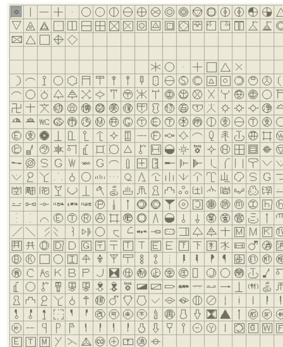
システムエリアの一部をユーザーに開放しました。これにより、特殊DMでマークが追加された時などは、ユーザーにて作成が可能になりました。システムエリアに登録されますので、マークとしての認識になるため、図面回転時や拡大、縮小時も他マークと同じ扱いになります。また、背面処理も対応しています。
